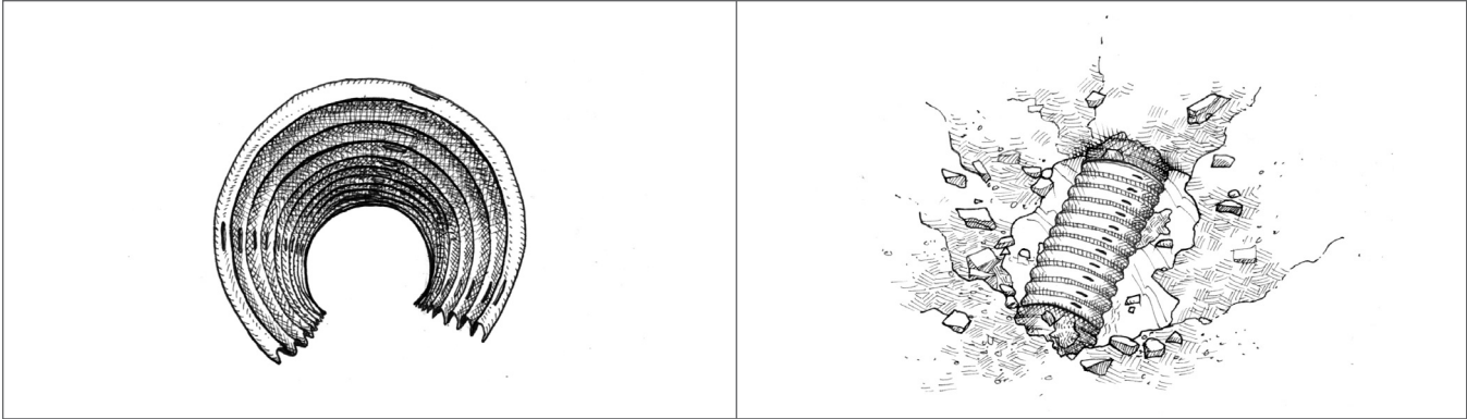
Figure 15. Morceau de drain qui s'insère sur le drain existant afin de recouvrir la partie ouverte pour l'examen du drain.
